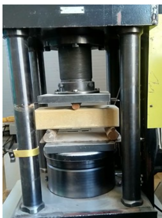
Рис. 4. Испытание образцов на прочность при изгибе
