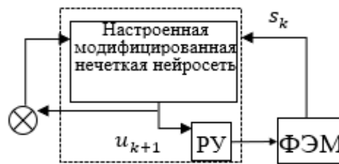
Схема интеллектуальной системы слежения за ТММ фотоэлектрического массива на основе настроенной модифицированной нечеткой нейросети. Сокращения: ФЭМ – фотоэлектрический массив, РУ – регулирующее устройство
