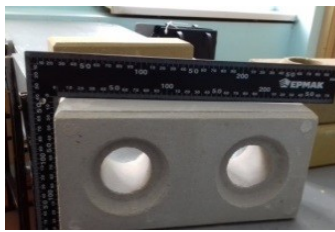
Рис. 2. Определение дефектов кирпича
