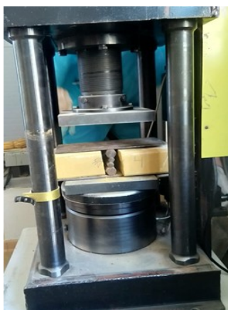
Рис. 5. Изготовление образцов-половинок для испытания на сжатие
