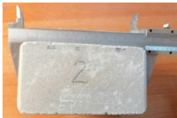
Рис. 1. Определение размеров кирпича
