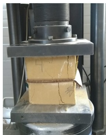
Рис. 6. Испытание образцов на прочность при сжатии
