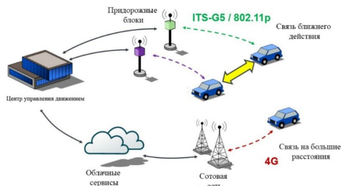
Рис. 3. Принципиальная схема работы Vehicle-to-Network, V2N
