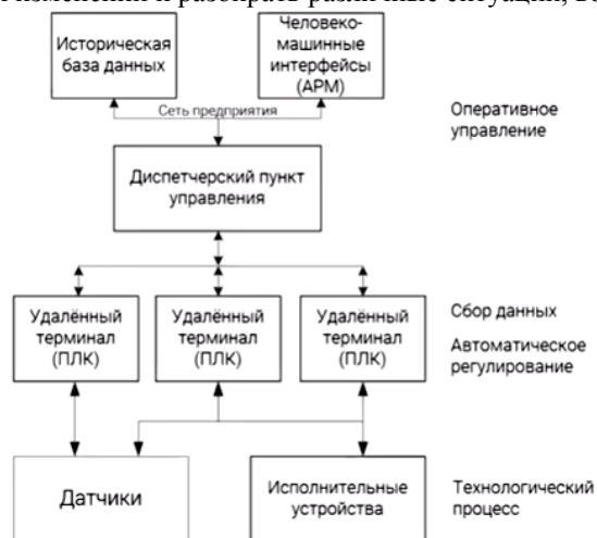
Типовая архитектура SCADA-системы
